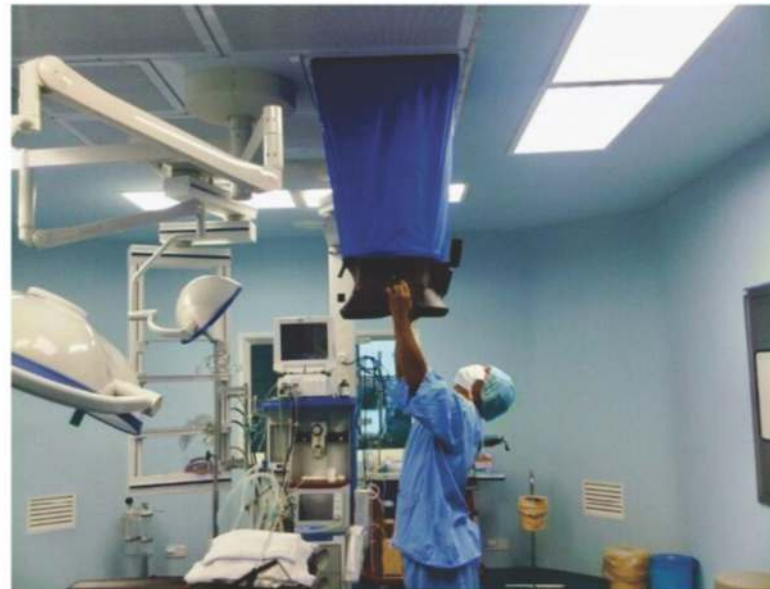
Figura 1.- Medición del volumen del flujo de aire utilizando el balómetro con campana de captura. Imagen de Tan H. et al. Systematic study on the relationship between particulate matter and microbial counts in hospital operating rooms.
